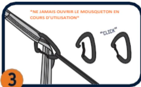
Attachez les mousquetons aux boucles de sangle souhaitées. Assurez-vous que chaque mousqueton s'enclenche et vérifiez visuellement que toutes les portes sont fermées avant de l'utiliser.
