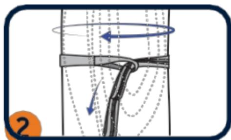
Enroulez les sangles autour des arbres à au moins 1,5 mètre du sol en enfilant l'extrémité à réglage multiple dans l'extrémité à boucle simple.
