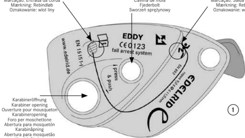
**Ansicht der festen Gehäuseflanke mit Steuerhebel - EDDY geschlossen**
