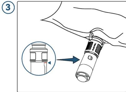
L'embout ne doit pas dépasser la ligne de la pompe.
