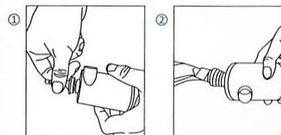
Placer la buse sur l'orifice d'admission
